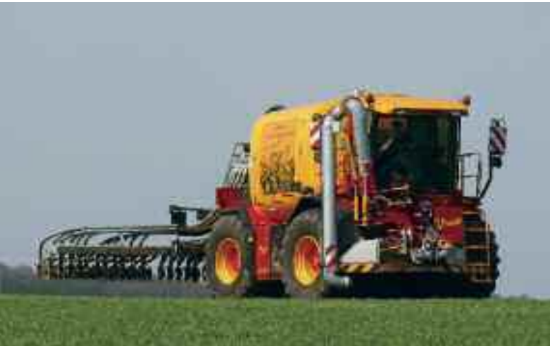
Emissionsarme Gülleausbringung auf Ackerflächen erfordert spezielle Ausbringungstechnik (hier: Kurzscheibenegge).
