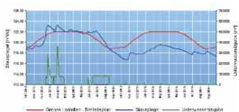
Entwicklung des Talsperrenpegels und der Unterwasserabgabe im Wasserwirtschaftsjahr 2013/2014 (im Vergleich zum Vorjahr)
