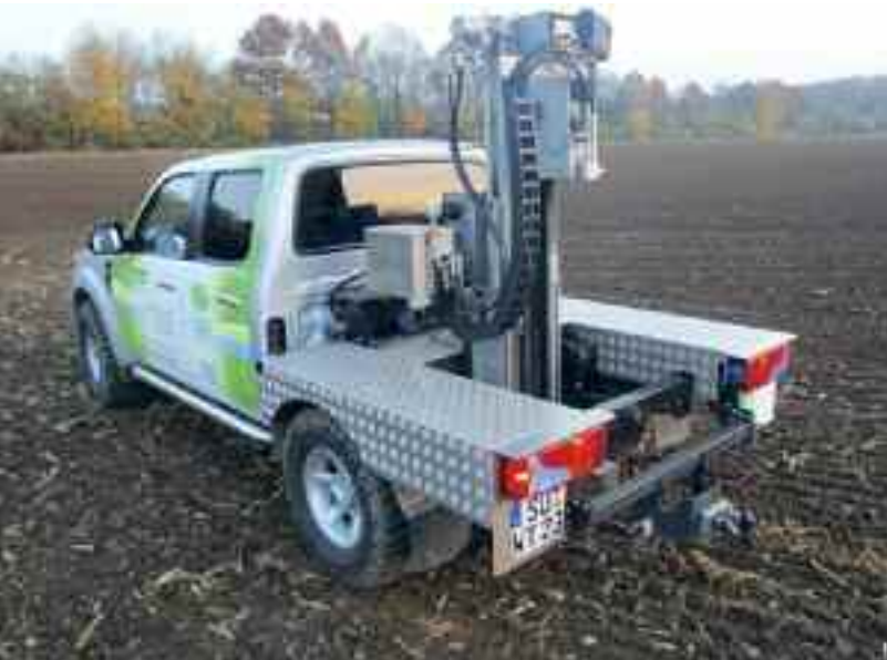
Das Bodenprobenahmegerät ist fest auf dem Caddy installiert und arbeitet vollautomatisch. Die N_{min} Bodenprobe kann in Minutenschnelle erfolgen.
