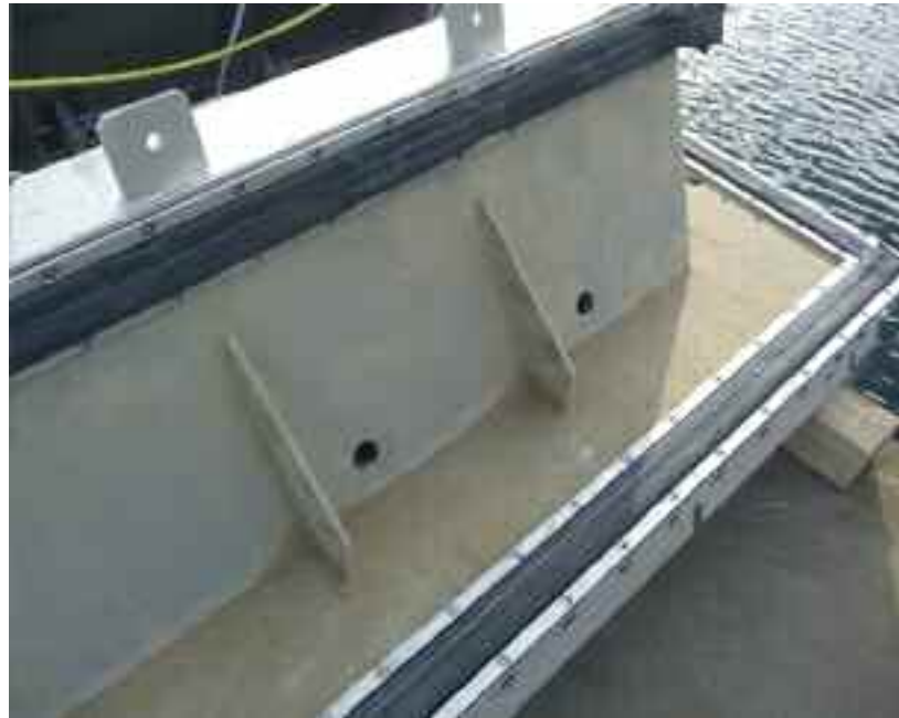
Pneumatische Dichtungen am Einlaufrahmen
