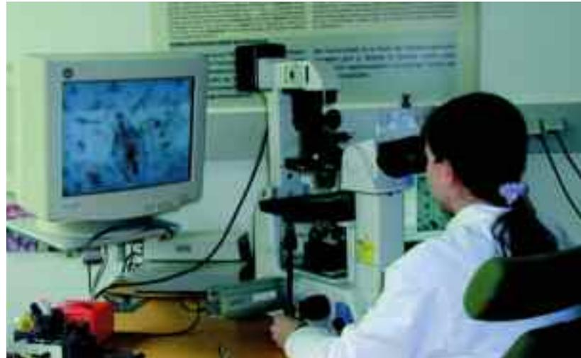
*Mikroskopische Analyse von Planktonproben am Umkehrmikroskop.*
