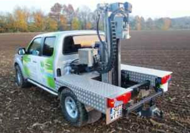
*Das Bodenprobenahmegerät ist fest auf dem Caddy installiert und arbeitet vollautomatisch. Die  $N_{min}$ -Bodenprobe kann in Minutenschnelle erfolgen.*
