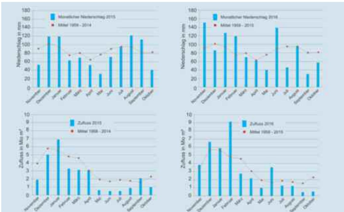
Stauspiegels geführt. Die Spitzen im Frühjahr, die über dem vorgegebenen Grenzwert lagen, wurden durch eine verstärkte Abgabe ans Unterwasser abgefahren. Die starken Niederschläge und daraus resultierende Zulaufmengen wurden ebenfalls durch eine entsprechende Abgabe ans Unterwasser abgefahren. Die Abgabe ans Unterwasser konnte dabei so gestaltet werden, dass es zu keiner deutlichen Überschreitung der vorgegebenen Stauspiegelgrenze gekommen ist. Die an-
