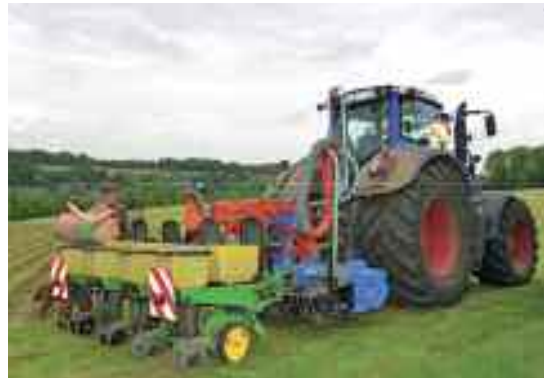
Die Streifenfräse zum Erosionsschutz wurde auf neun Hektar in den Wasserschutzgebieten eingesetzt.
