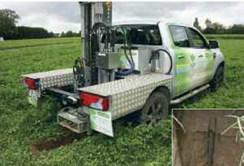
Das Bodenprobenahmege- rät ist fest auf dem Caddy in- stalliert und arbeitet voll- automatisch. Die N_{min} - Bodenprobe kann in Minu- tenschnelle erfolgen.
