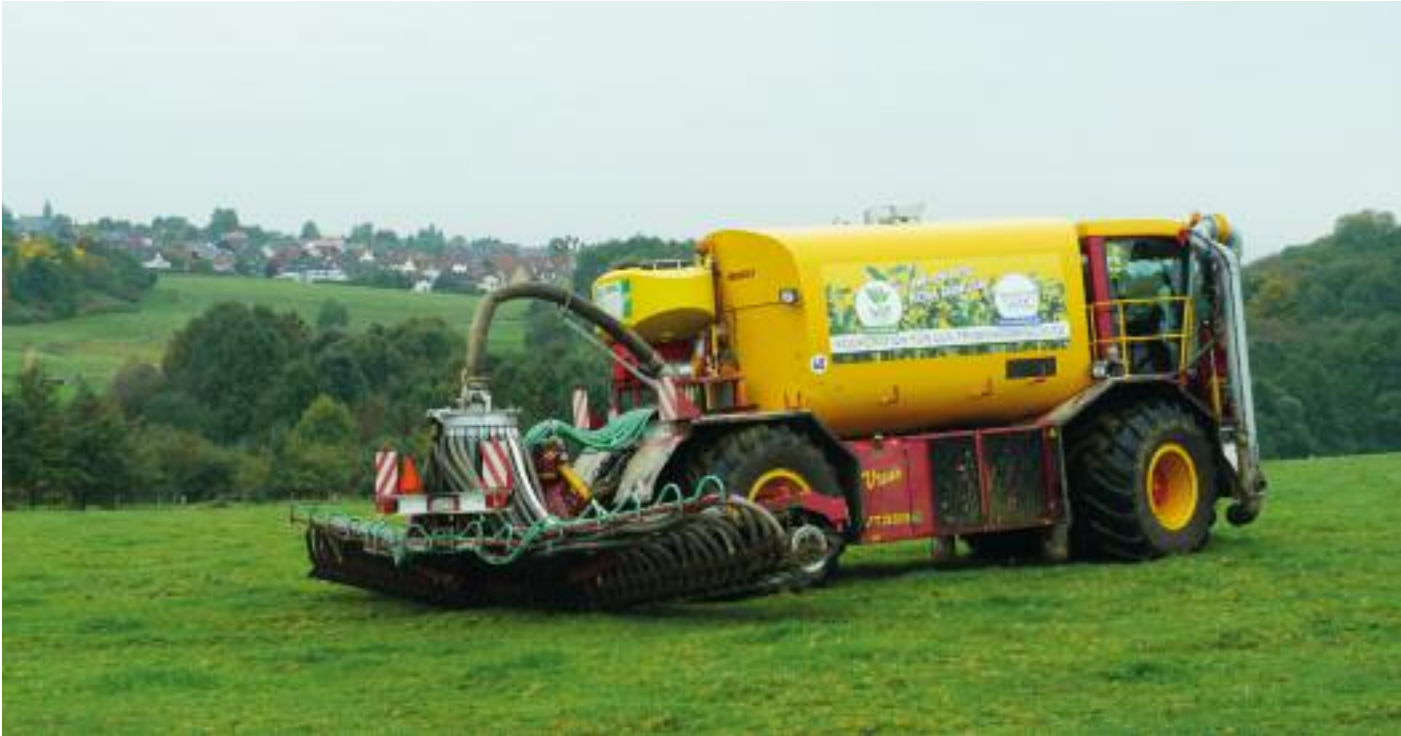
Gülleausbringer mit bodennahe Schlitz- und Verteiltechnik
