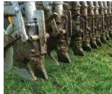
Durch die Schlitztechnik kann die Gülle emissionsarm in das Grünland ausgebracht werden
