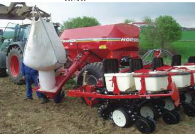
Gewässerschützende Direktsaatmaschine ohne pflügende Bodenbearbeitung im Mais- und Getreideanbau
