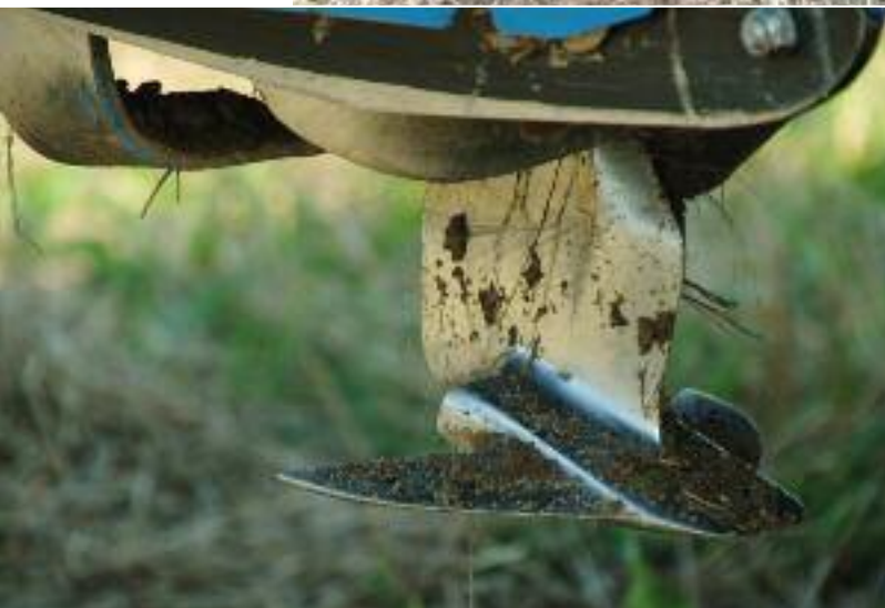
Strip-Till-Maschine zur streifenweisen Auflockerung des Bodens
