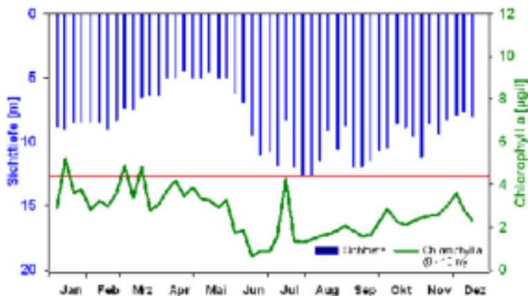
Saisonaler Verlauf der Chlorophyll a-Konzentrationen in integrierenden Wasserproben aus 0 – 10 m sowie der Sichttiefe an Messboje A im Jahr 2014.
