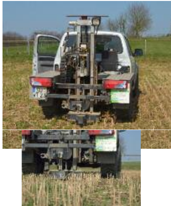
Vollautomatisiertes und standardisiertes N_{min} -Bodenprobennahmegerät für eine 90 cm Durchwurzelungstiefe. Nitrat und Ammoniumstickstoff werden zum Zeitpunkt der Bodenprobennahme in der Bodenlösung analysiert.
